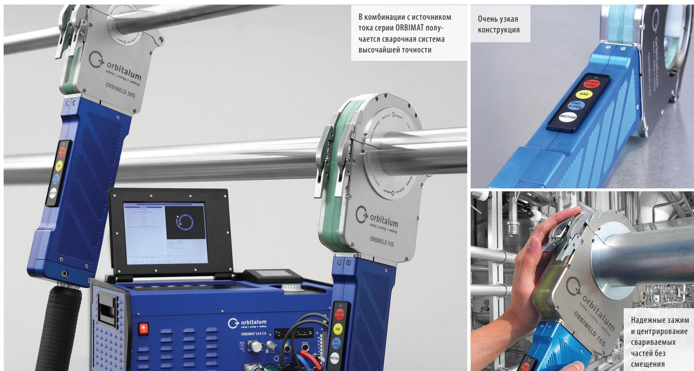
В комбинации с источником тока серии ORBIMAT получается сварочная система высочайшей точности
