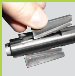
Система зажима "с ЧПУ" с закрепленными на мачте затяжными шпонками просто незаменима!
