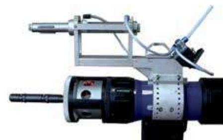
Пневматическое центрирующее устройство
