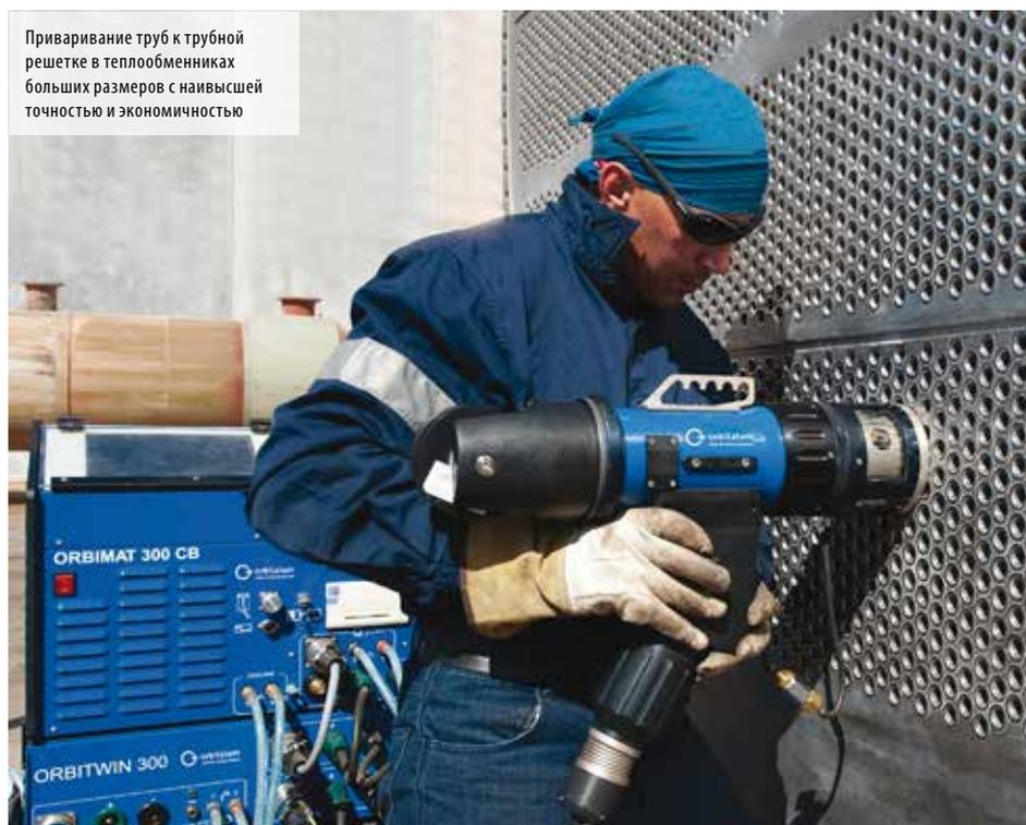
Приваривание труб к трубной решетке в теплообменниках больших размеров с наивысшей точностью и экономичностью
