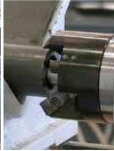
Стандартизованная, точная и воспроизводимая подготовка сварных швов
