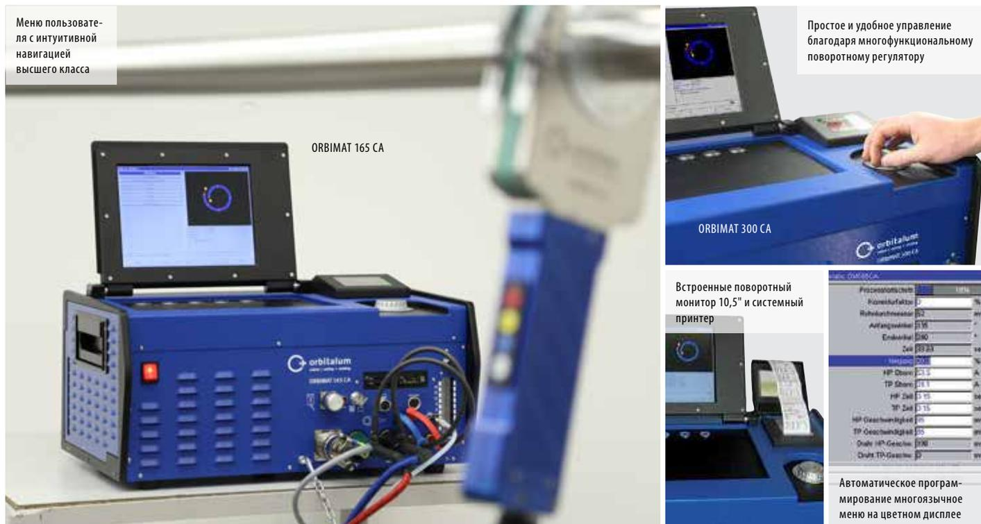
Наряду с хорошо зарекомендовавшим себя автоматическим программированием компании Orbitalum с вводом диаметра трубы, толщины стенки, материала и сварочного газа, все модели ORBIMAT CA имеют функцию "Flow Force" для уменьшения времени истечения газа при закрытых головках, а также возможность подключения устройства внутреннего давления газа, защищающего корень шва "BUP Control Box".
