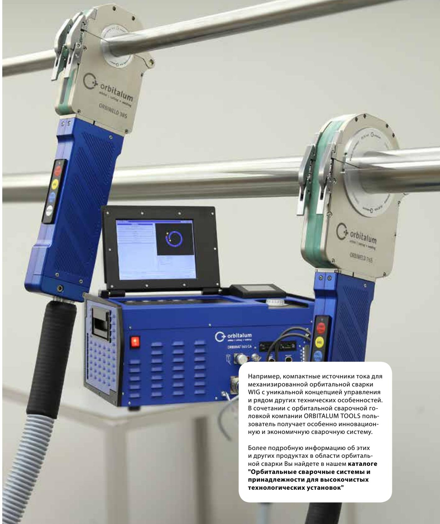
Например, компактные источники тока для механизированной орбитальной сварки WIG с уникальной концепцией управления и рядом других технических особенностей. В сочетании с орбитальной сварочной головкой компании ORBITALUM TOOLS пользователь получает особенно инновационную и экономичную сварочную систему.
