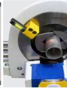
Встроенный лазерный указатель для маркировки мест обрезки на трубе
