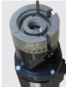
Отрезка электродов (например, с помощью ESG MAX)
