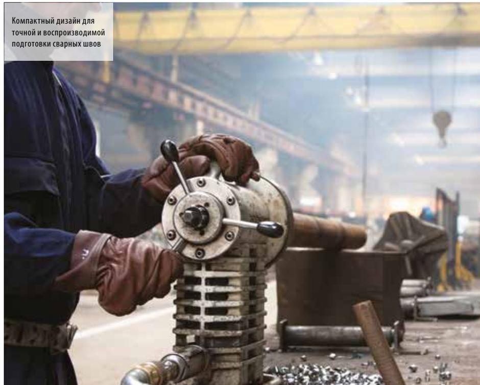
Компактный дизайн для точной и воспроизводимой подготовки сварных швов
