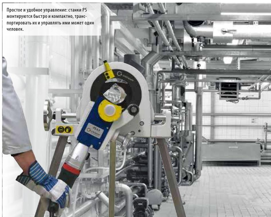
Простое и удобное управление: станки PS монтируются быстро и компактно, транспортировать их и управлять ими может один человек.
