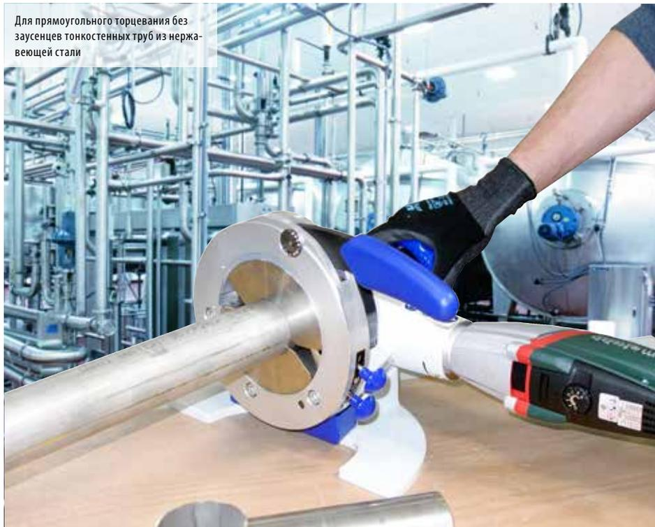
Для прямоугольного торцевания без заусенцев тонкостенных труб из нержавеющей стали
