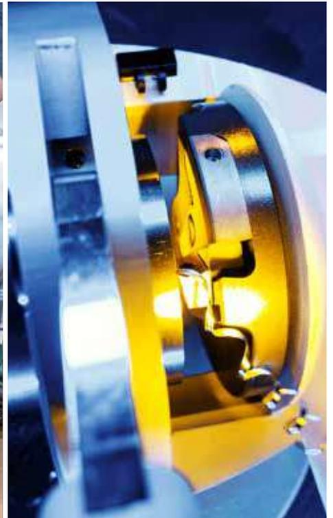
**С высокой точностью пользователь может быстро, без заусенцев и абсолютно прямоугоньно с помощью RPG 4.5 обрабатывать концы труб до 114,4 мм (4.5"), а с помощью RPG 8.6 – внешний диаметр трубы до 219,1 мм (8.6").**
