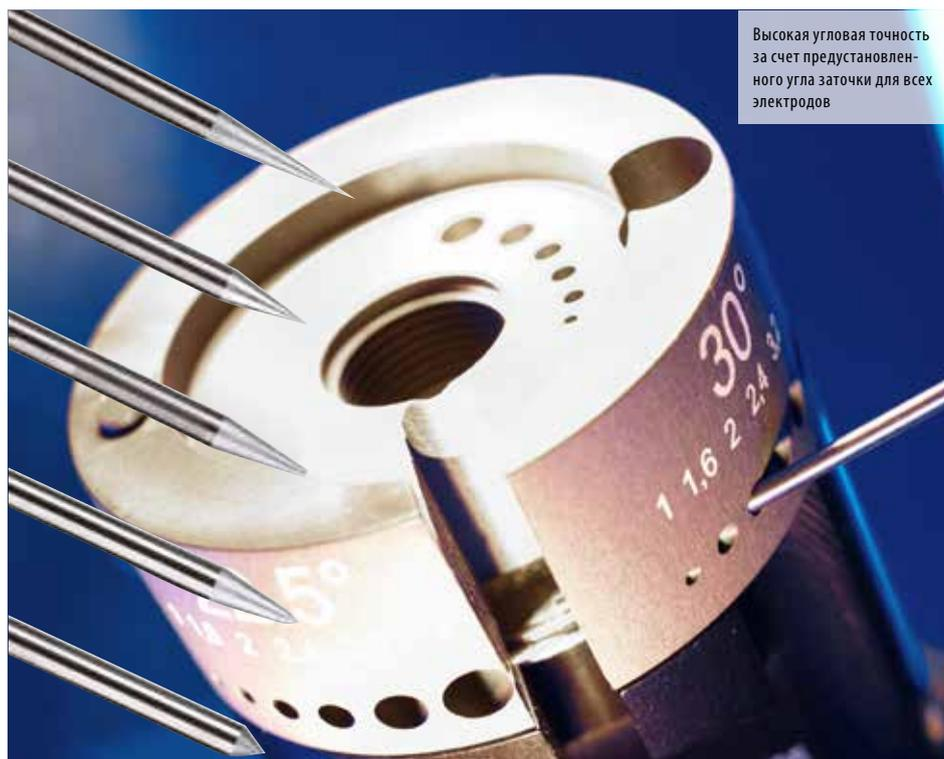
Высокая угловая точность за счет предустановленного угла заточки для всех электродов
