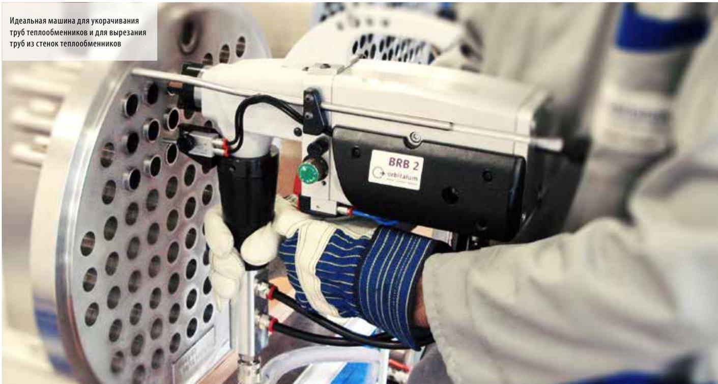
**Для стандартизованной, точной и воспроизводимой подготовки сварных швов. Идеальное дополнение к сварочным головкам WIG для приваривания труб к трубной решетке компании Orbitalum!**
