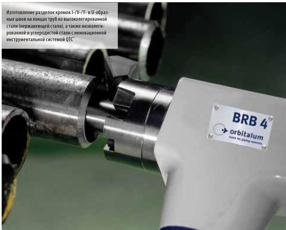
Изготовление разделок кромок I-/V-/Y- и U-образных швов на концах труб из высоколегированной стали (нержавеющей стали), а также низколегированной и углеродистой стали с инновационной инструментальной системой QTC
