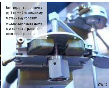
Благодаря состоящему из 3 частей зажимному механизму головку можно зажимать даже в условиях ограниченного пространства
