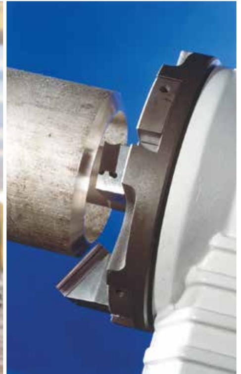
**Мощное решение для обработки концов труб. Изготовление высокоточных и воспроизводимых форм разделки кромок сварных швов на концах труб из высоколегированной стали (нержавеющей стали), а также низколегированной и углеродистой стали с инновационной инструментальной системой QTC®. Возможность использования до 4 инструментов одновременно.**
