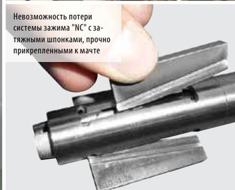
Невозможность потери системы зажима "NC" с затяжными шпонками, прочно прикрепленными к матце
