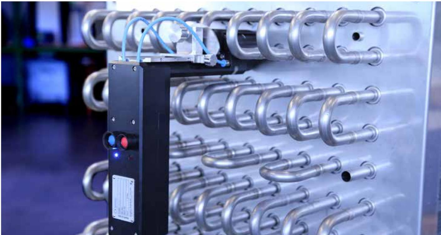
**Все имеющиеся на рынке закрытые головки для орбитальной сварки или открытые сварочные клещи из-за их типоразмера не подходят для их расположения между отдельными трубами пластинчатых теплообменников.**
